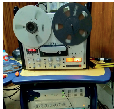
Setup general de transcripción de cinta magnética (Revox PR-99, Cabeza Butterfly two channel, Digidesign HD192)
