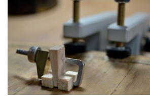
Reforzamiento de la tapa
